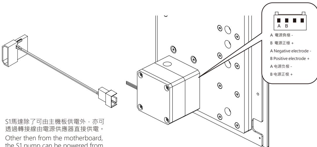
S1馬達除了可由主機板供電外，亦可透過轉接線由電源供應器直接供電。
