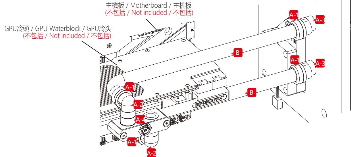
注意：跑水前，請先確認所有零件已安裝在正確的位置上，在不開主機，單開水泵的情況下，進行24小時的跑水測試，確保無漏水情況後再開主機，避免發生漏水而導致電腦零件的損壞。
